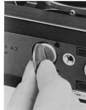
NC-Zellen verwendet werden, die in voll aufgeladenem Zustand zur Belichtung von etwa 60 bis 80 Filmen zu 36 Aufnahmen ausreichen. Einzelheiten über das Aufladen der NC-Zellen findet man in deren Gebrauchsanweisung.
