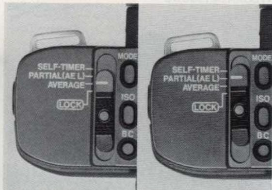
Ungachtet der eingestellten Betriebsart kann die Kamera blitzschnell von mittenbetonter Integral- auf Selektivmessung und umgekehrt geschaltet werden. Dies geschieht mit Hilfe des Hauptschalters.
