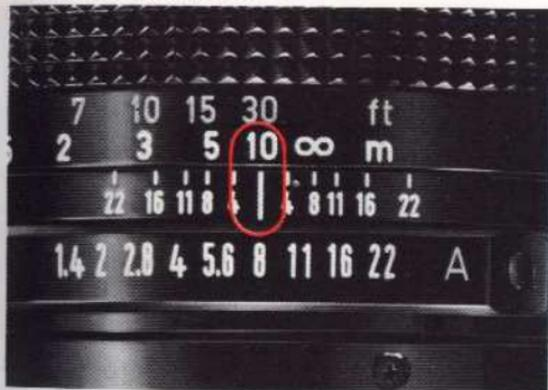
Bei Verwendung von Schwarzweiß-Infrarotfilm ist eine geringe Fokuskorrektur erforderlich. Hierfür besitzen die meisten Canon-Objektive einen roten Infrarotindex.
