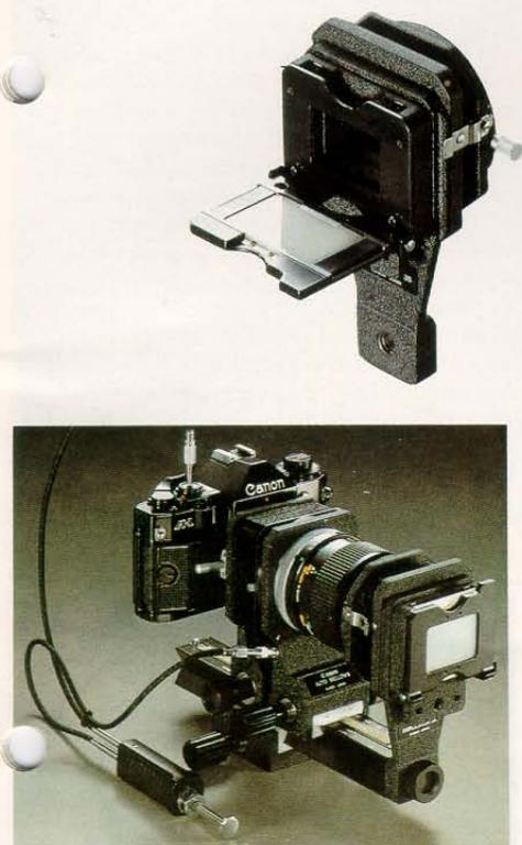
Das **Diakopiergerät 35** wird wie der Makrotisch an die Vorderseite des Automatik-Balgeneräts angesetzt und dient zur Reproduktion von Kleinbilddias. Es sollte mit einem Makro-Objektiv FD 1:3,5/50 mm verwendet werden. Beim Einsatz dieses Objektivs in Retrostellung lassen sich auch Poket-Dias auf Kleinbildformat umkopieren. Ausschnittvergrößerungen sind durch die Möglichkeit einer Verschiebung der Bildbühne in zwei Richtungen un schwer zu erzielen.
