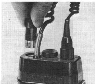
リモートスイッチMDの接続 Connecting the Remote Control Switch MD
