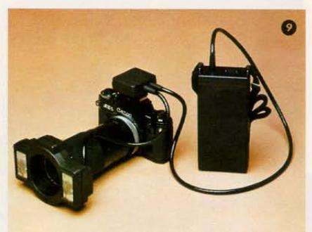
① Zwei spezielle Kopiergeräte erlauben in Verbindung mit dem Automatik-Balgenerät die Duplizierung einzelner 16-mm- bzw. 8-mm-Schmalfilmbilder auf Kleinbildfilm.
